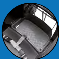
Assoalho removível para acessar os pedais e cinto de segurança de três pontos
